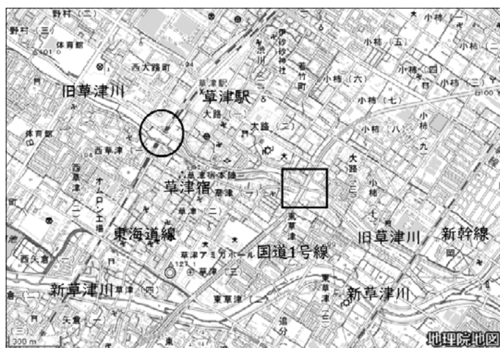
図14：旧草津川（現・草津川跡地公園）と新草津川の地図（国土地理院地図に筆者が書き込みした）で、図の○印はJR東海道線の旧草津川の川床下のトンネルで、図の□印は国道1号が旧草津川と交差するところを示している。東海道線のトンネルは以前のままだが、国道1号線のトンネル部分の旧草津川は取り払われ、横断用の橋が取り付けられている。
